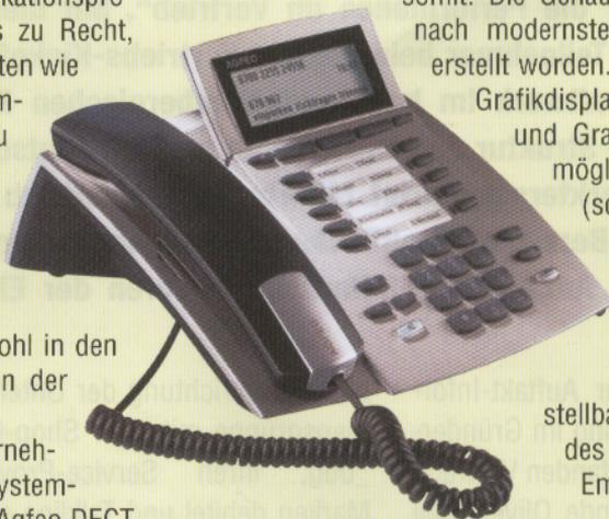
Zwei Modulschächte für zukünftige Technologien und ein Anschluss zur Anbindung von schnurlosen und schnurgebundenen Agfeo Headsets sind ebenfalls vorhanden. Zehn Funktionstasten mit Status-LED für 20 häufig benötigte Anlagenfunktionen und Rufnummern sowie der Zugriff auf das TK-Anlagentelefonbuch und Computertelefonie (CTI) runden die Komfortmerkmale des Agfeo ST 40 IP ab.
