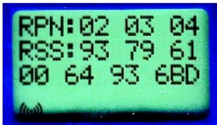
Zum Ausmessen der idealen Standorte ist die unterste Zeile des Displays die wichtigste. Die erste Zahl gibt die Station an, auf der das Handy gerade angemeldet ist, in diesem Falle die Basisstation (00).
