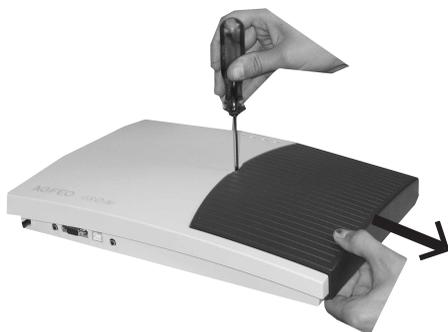
**! ACHTUNG: Vor dem Öffnen des Gehäuses - 230 V-Netzstecker der TK-Anlage aus der Steckdose ziehen!**
