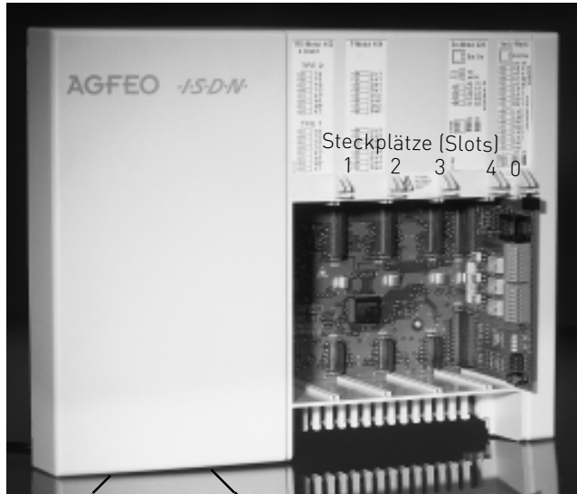
Abb. 1 TK-Anlage mit abgenommenem Deckel
